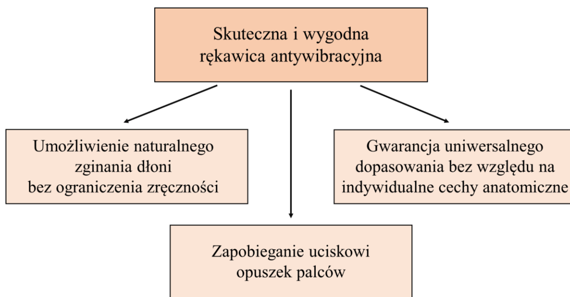
Rys. 8. Aspekty dotyczące komfortu użytkowania rękawicy antywibracyjnej uwzględniane podczas projektowania prototypu rękawicy
