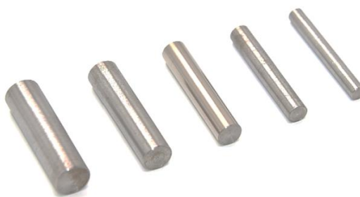
Rys. 6. Pręty ze stali nierdzewnej o długości 40 mm i średnicach odpowiednio 11, 9,5, 8, 6,5 i 5 mm
