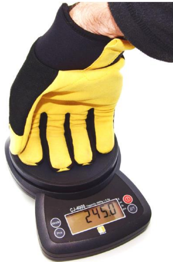
Rys. 7. Metoda orientacyjna pomiaru wartości siły, jaka jest potrzebna do zginania palców ręki o 90° w rękawicy antywibracyjnej
